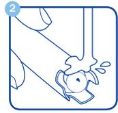
**2 Enjuague la punta de la sonda de pH en agua corriente limpia.** NO utilice agua de ósmosis inversa, agua destilada ni agua desionizada.
