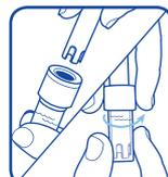
Asegúrese de que la punta de la sonda está sumergida en solución de almacenamiento KCl en la tapa
