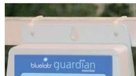
Bridas de cable fijadas a través de pequeños orificios de montaje alrededor de un soporte o barra.
